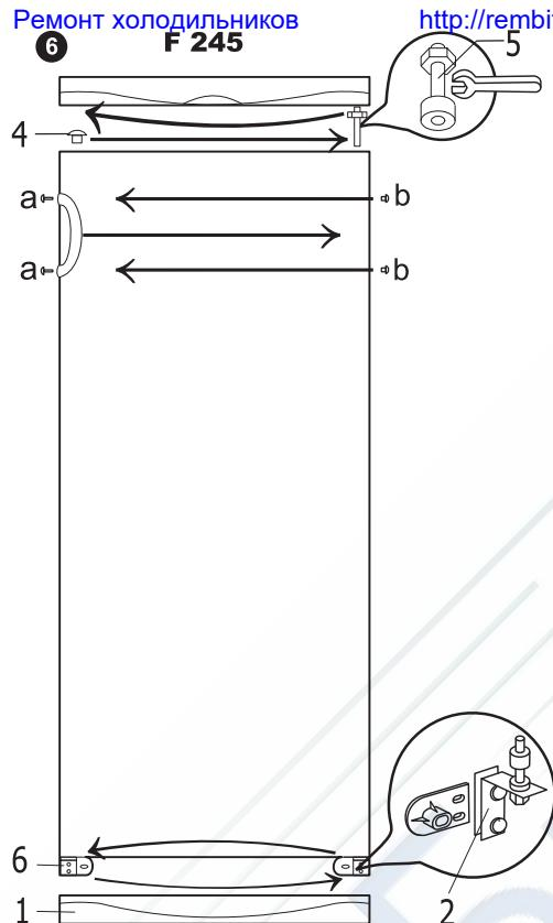
4. На противоположной стороне вкрутите по часовой стрелке шпильку **5** вместе с гайкой и шайбами.
