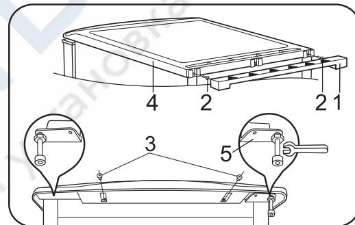
7. Поставьте дверцу морозильной камеры на шпильку кронштейна **8**. Прикрепите кронштейн **5** вместе с шайбами на шпильке.
